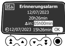
4. Die Pfeiltasten drücken, um das Intervall vor dem Alarm in Stunden und Minuten ( \_\_ h \_\_ min) anzugeben.
