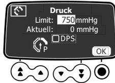
4. Mithilfe der Pfeiltasten das Drucklimit erhöhen oder senken.
