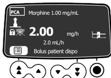
2. Appuyer sur la touche de gauche d'incrémentation rapide pour sélectionner le résumé des paramètres PCA (icône de liste), au-dessus de la touche sur l'écran.
