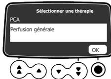
Si **PCA** est sélectionné, un mot de passe doit être saisi dans l'écran suivant affiché.
