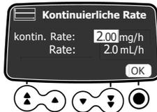
1. Mit den Pfeiltasten einen Wert für die Rate eingeben, je nach zuvor gewählter Einheit in mL/h oder mg/h.
