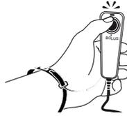
Wenn aufgrund des Sperrzeitraums zwischen zwei aufeinanderfolgenden Boli kein PCA-Bolus verfügbar ist, oder wenn die maximal zulässige Anzahl an Boli erreicht wurde, gibt die Infusionspumpe bei Drücken der Bolus-Taste einen Signalton aus und die LED am Patiententaster blinkt, aber die Infusionspumpe verabreicht den Bolus nicht.
