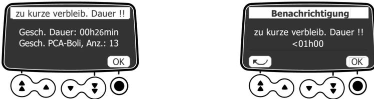
Abbildung 19: Meldung, dass die verbleibende Dauer zu gering ist
