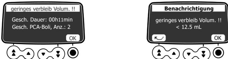
Abbildung 17: Meldung, dass das verbleibende Volumen zu gering ist
