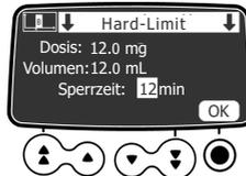
2. Die Abbildung zeigt den Bildschirm, der angezeigt wird, wenn versucht wird, den **Sperrzeit**-Wert zu verringern. Der nächste Programmierbildschirm wird angezeigt und die Programmierung der Infusion kann fortgesetzt werden.
