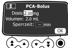
1. Mit den Pfeiltasten einen Wert für die Dosis eingeben, je nach zuvor gewählter Einheit mL oder mg. Bei Eingabe eines Werts für eine Dosis wird das entsprechende Volumen automatisch angezeigt.
