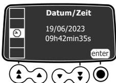
Wenn die Agilia Infusionspumpe drahtlos mit dem Server der Vigilant Software Suite verbunden ist, werden das Datum und die Uhrzeit der Pumpe automatisch auf das Datum und die Uhrzeit des Servers gesetzt.
