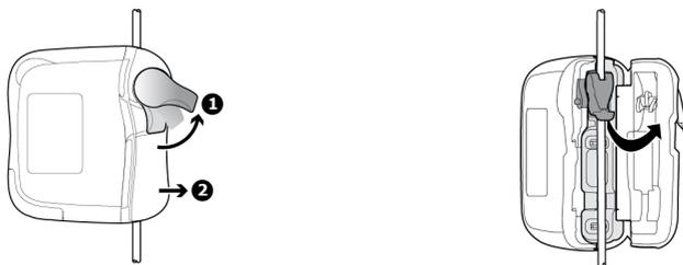
Installer une nouvelle tubulure dans la pompe (voir *Installation de la tubulure* à la page 18).
