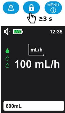
**NOTE :** Un bip retentit quand le verrouillage du clavier est activé.
