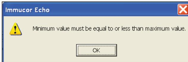
Erro apresentado quando o valor do comprimento mínimo do nome do utilizador definido é superior ao valor do comprimento máximo
