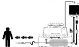
6. Quando o equipamento estiver totalmente preenchido, feche a pinça de controle de fluxo e verifique a ausência de bolhas de ar.
