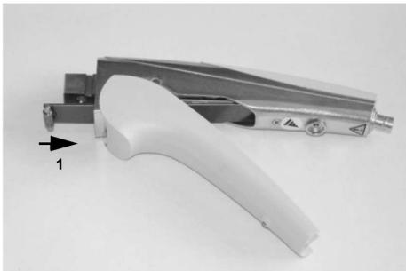
Insira completamente a mola de lâmina no selador manual (1).
