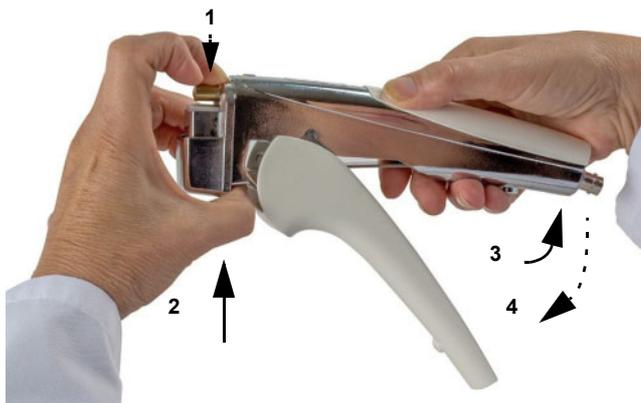
Firmemente fechar a cabeça de selagem móvel, empurrando-a com o dedo do meio (1) e, simultaneamente, exercendo uma contra pressão sobre a peça imóvel com o polegar (2). Comprimir (3) e soltar repentinamente (4) a alavanca.
