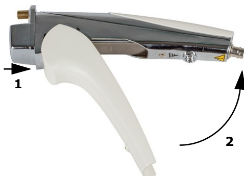
Fig. 67 Selador manual - inserir o cabeçote de selagem
