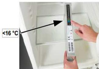
O elemento de refrigeração está suficientemente refrigerado quando o termômetro indicar <16°C (ver figura) e o líquido de refrigeração estiver completamente solidificado. O elemento de refrigeração está suficientemente refrigerado se, ao fazer uma agitação repetida no sentido horizontal, não se ouvir um som de raspagem.
