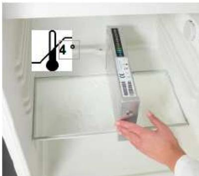
Ativar o elemento de refrigeração na geladeira (4 °C) (solidificação completa do líquido de refrigeração), até que o termômetro indique uma temperatura menor ou igual a 16 °C. O tempo de refrigeração numa geladeira com temperatura de 4°C é de aproximadamente 10 a 14 horas. Se a fita indicadora de temperatura estiver completamente escura, a temperatura é de aproximadamente 4 °C.
