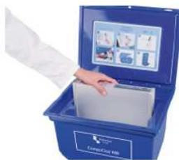
Colocar o elemento de refrigeração na mala térmica com o termômetro virado para cima
