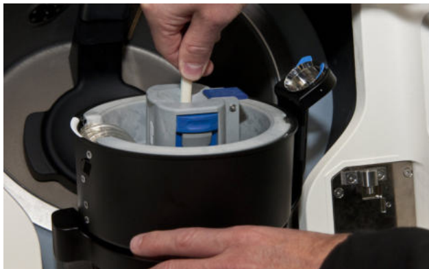
4.18 Suporte da junta do umbilicus corretamente instalado
