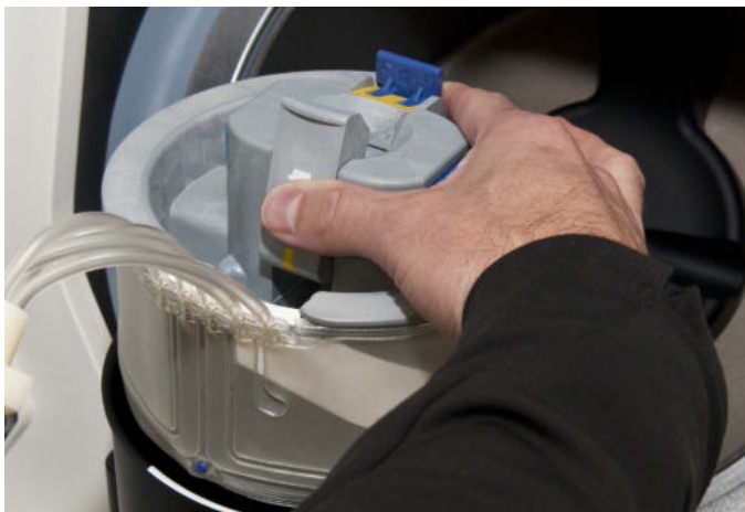
4.14 Abertura do suporte da junta inferior do umbilicus
