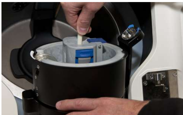
4.18 Suporte da junta do umbilicus corretamente instalado
