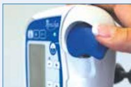
Fermer la porte, enfoncer le levier pour le verrouiller fermement en place.
