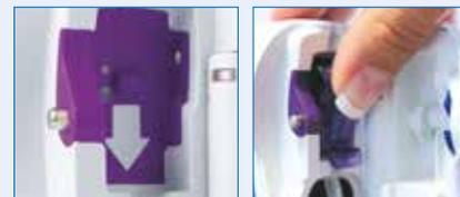
Positionner la pince de retenue de la tubulure de sorte qu'elle soit alignée avec la flèche vers le bas jusqu'à ce qu'elle se « clique » en place.
