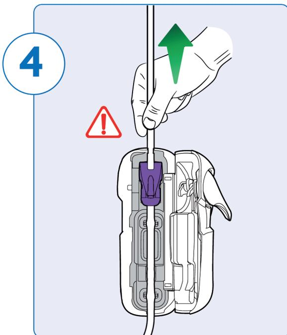
Schlauch leicht nach oben ziehen, um die Schlauchklemme in eine optimale Position zu bringen.
