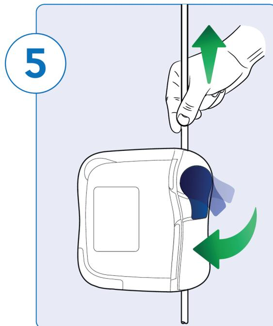
Schlauch leicht gespannt halten und Pumpentür mittels blauem\* Griff nach unten verriegeln. Türe nicht zudrücken und keine Kraft anwenden.
